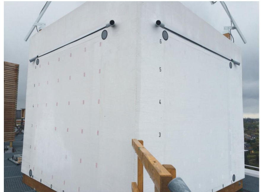
Wandfläche teilweise feucht - Messfelder verfärbt
