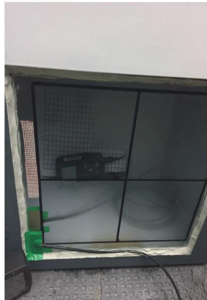
Abnahme des angefallenen Oberflächenwassers im Viertelbereich der Glasscheibe durch Abwischen mit einem Zellstofftuch
