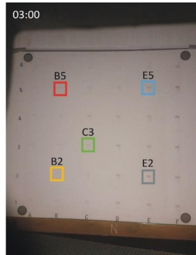
Beginn Tauwasserbildung siehe Felder E2, E5
