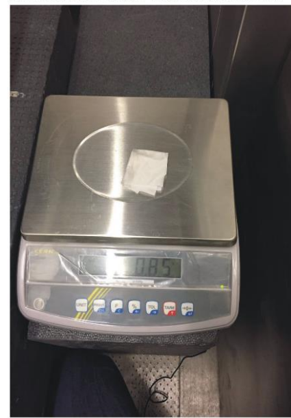
Wiegen des Zellstofftuchs unmittelbar nach Wasserabnahme
