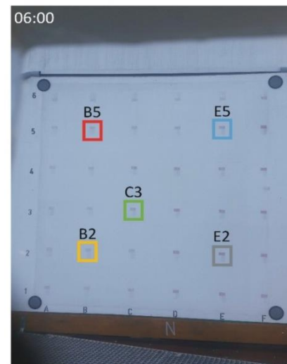
Betaute Wand nach Sonnenaufgang, sichtbar an rot verfärbten Feuchtedetektoren
